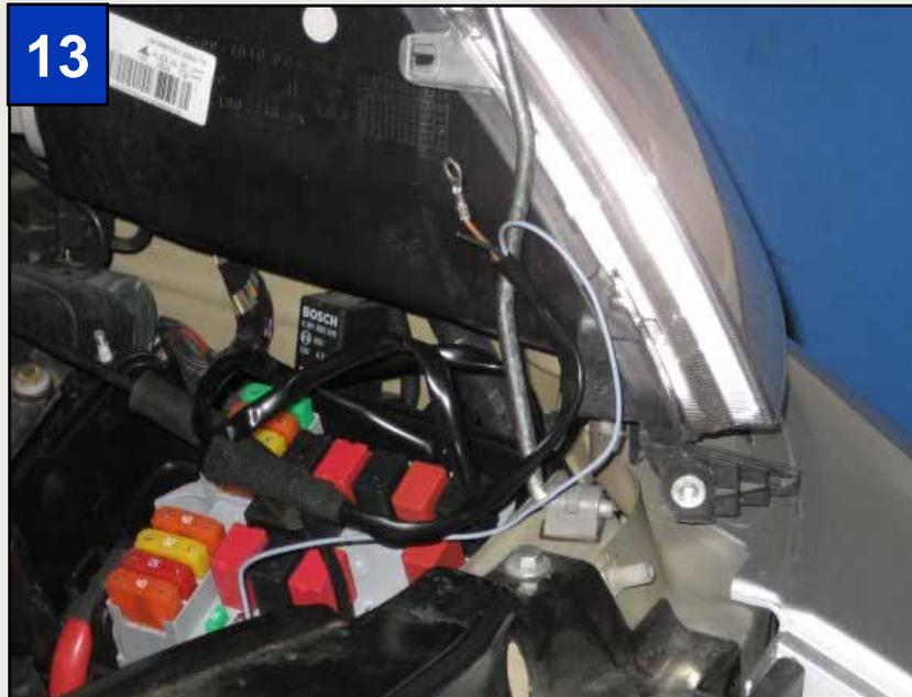
Nun kann der Profikabelsatz an die Klemme 15 (Zündungsplus), die Klemme 58 (Positionslichtfunktion) und die Klemme 31 (Massepunkt) angeschlossen und im Motorraum verlegt werden.
