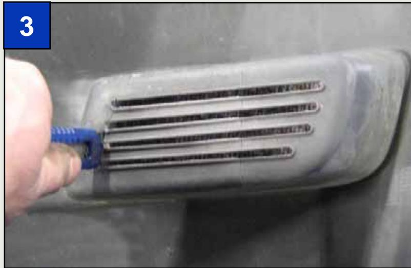
Im nächsten Schritt muss das Gitter aus der Verkleidung entfernt werden, damit hier später die Leuchten eingesetzt werden können.
