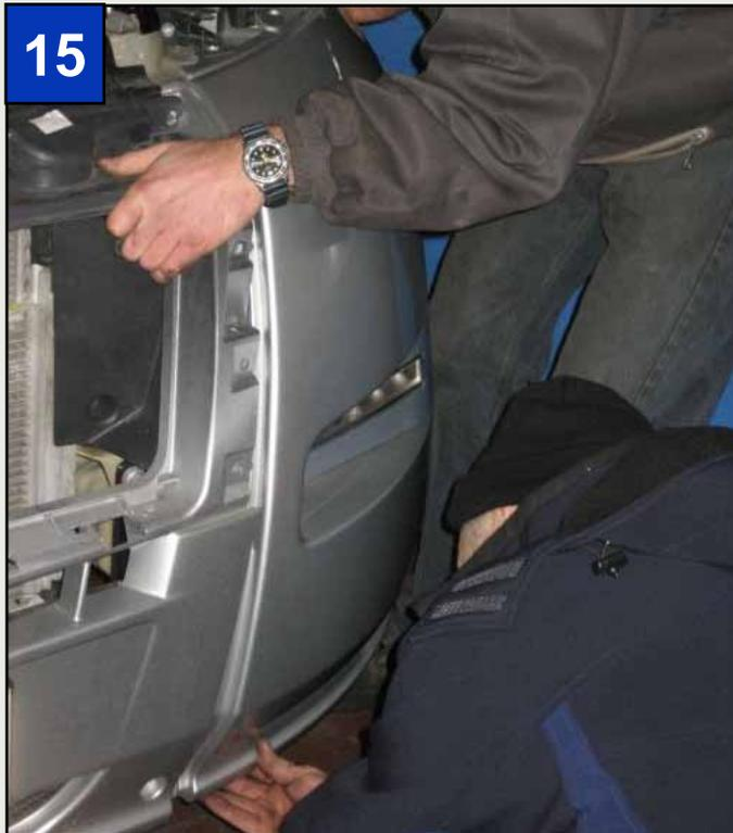
Nachdem das Kabel im Motorraum verlegt wurde, können die beiden anderen Enden an die Tagfahrleuchten angeschlossen werden. Anschließend muss nur noch die Verkleidung des Fiat Ducatos wieder angebracht werden.
