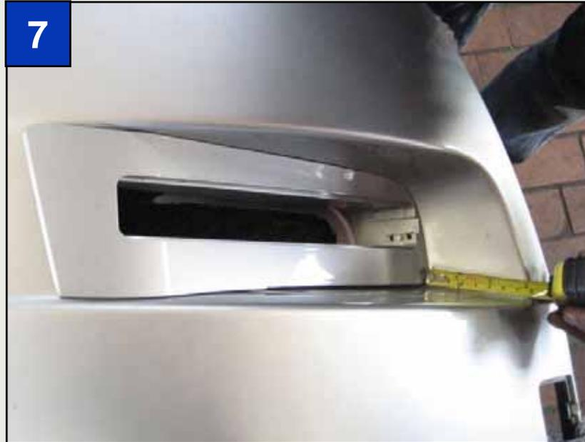
Für eine korrekte Platzierung und optimale Passgenauigkeit, messen Sie zunächst genau aus, wo die Schrauben befestigt werden sollen.
