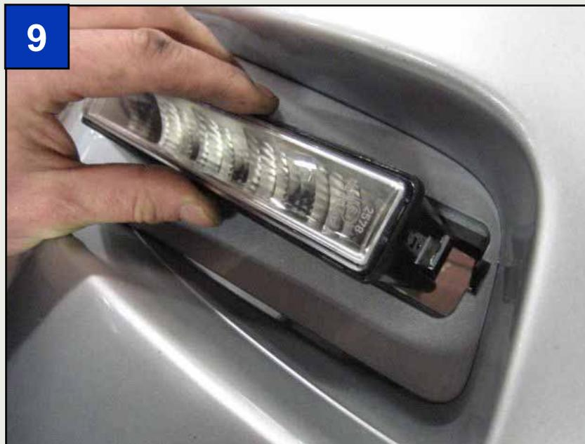
Die Leuchten können ganz einfach in die Blenden eingesetzt werden. Durch das Einrasten der Bügel (seitlich an den Tagfahrleuchten) sitzt die LEDayLine fest in der Halterung.
