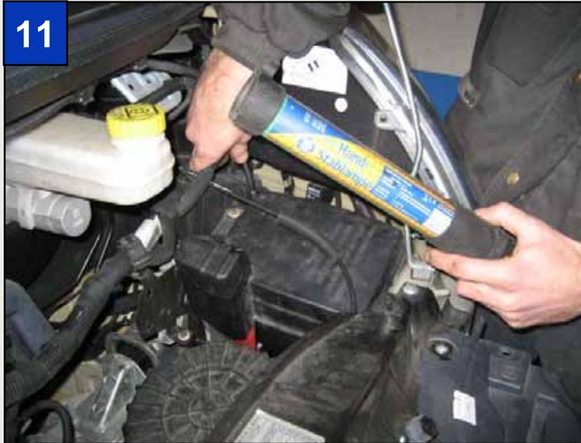
Der Sicherungskasten befindet sich bei dem Fiat Ducato im Motorraum. Um das im Set enthaltene Kabel an die entsprechenden Klemmen anschließen zu können, entfernen Sie zunächst den Schutzaufsatz des Sicherungskastens.
