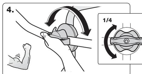
**S** 1. Montera vredet enl. bild. 2. Dra åt skruven tills det inte går att lossa vredet med handkraft. 3-4. Lossa skruven 1/2 varv i taget tills man med handkraft kan vrida vredet (**vredet skall gå trögt när det lossas**).
