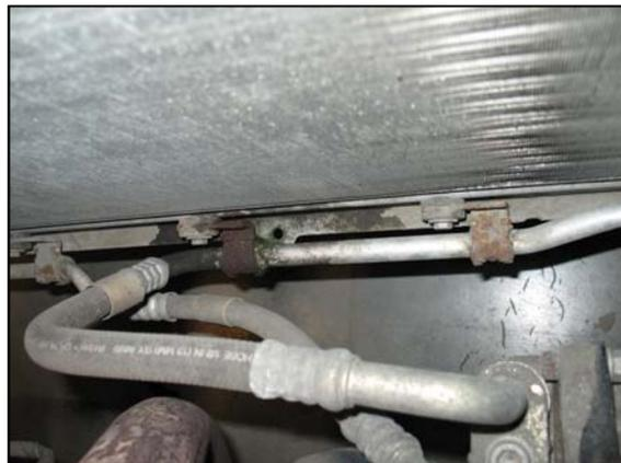
Viga leiti läbi korrodeerunud vaakumpoolse torust.
