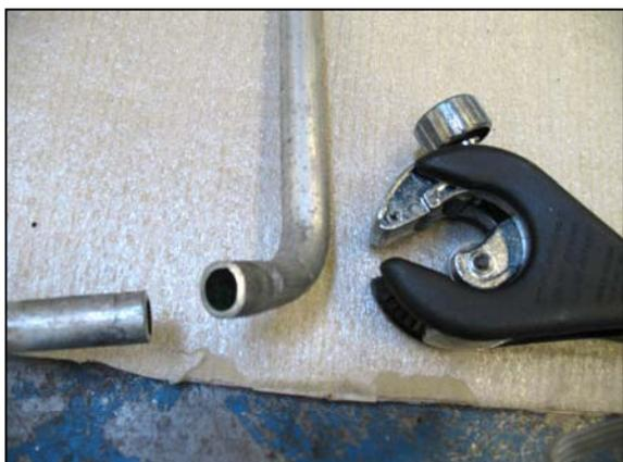
Korrodeerunud koht lõigatakse välja torulõikuriga: 8PE-351-229-141.
