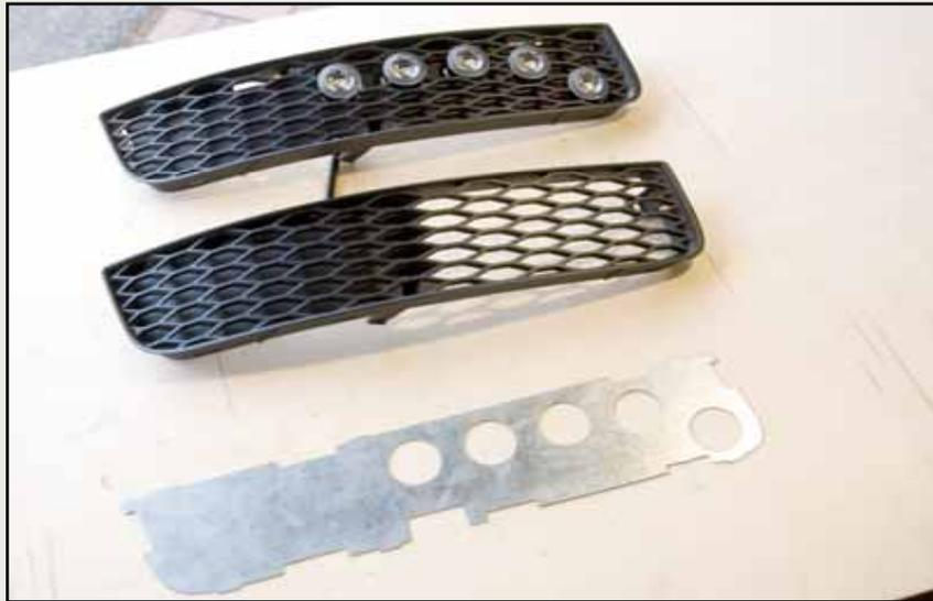
Die einzelnen LED-Module müssen nun montiert werden. Hierzu bieten sich die rechte und die linke Blende der Frontstoßstange an. Da es sich um ein Universal-Tagfahrleuchten-Set handelt, müssen die Blenden selbst bearbeitet werden.
