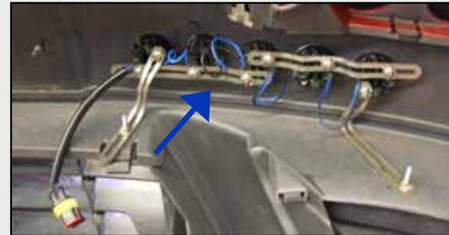
Diese können dann individuell an die jeweilige Anbausituation angepasst werden. Wichtig ist, dass die angefertigten Halterungen gut gegen Korrosion geschützt sind. Zu empfehlen sind daher Halterungen aus Edelstahl, Aluminium oder verzinktem Material.
