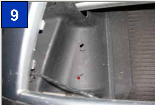
Nachdem die Leuchten in dem Gitter befestigt wurden, wird nun der fahrzeugseitige Anschluss durchgeführt. Zunächst benötigt man hierfür einen geschützten Ort um die Elektronikboxen des Steuergerätes anzubringen.
