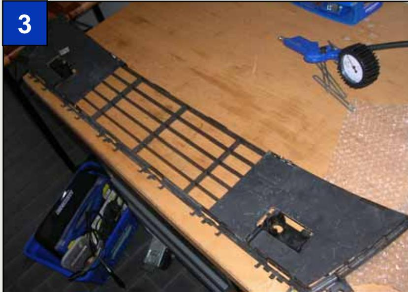
Nachdem das Gitter ausgebaut worden ist, werden die zwei Spritzschutzblenden entfernt.
