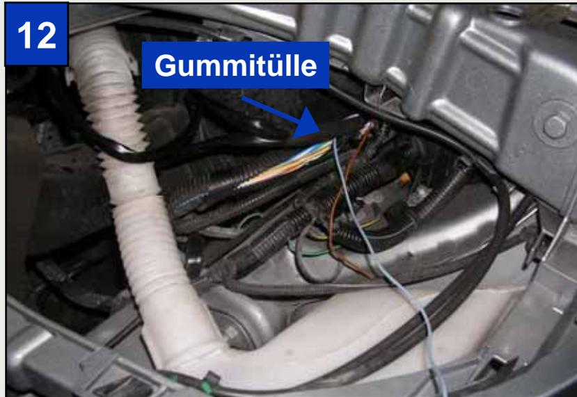
Nachdem auf der Fahrerseite der Scheinwerfer ausgebaut wurde, um den Massepunkt, das Positionslicht sowie die Kabeldurchführung zum Sicherungskasten zugänglich zu machen, kann das graue Kabel des Profikabelsatzes mit einem Abzweigverbinder an den Pluspol des Positionslichts angeschlossen werden.
