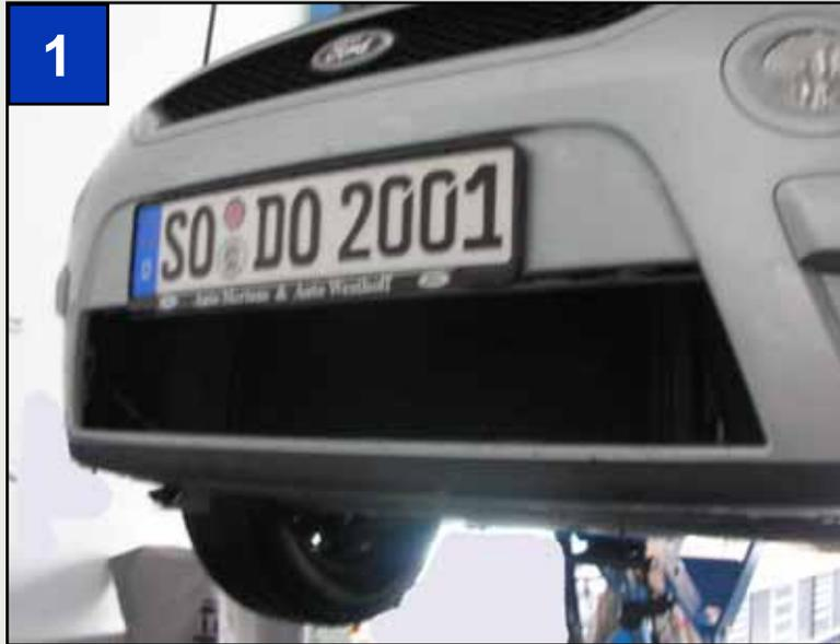
Um nun die Tagfahrleuchten einbauen zu können, wird der Grill ausgerastet und aus der Frontstoßstange ausgebaut.
