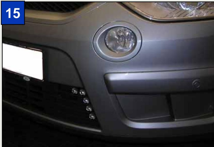
Nachdem der Profikabelsatz im Motorraum verlegt wurde, muss nur noch das Gitter zurück in die Fahrzeugfrontschürze gesetzt und die Tagfahrleuchten an die Elektronikboxen angeschlossen werden. Danach kann der Scheinwerfer wiedereingebaut und der Unterbodenschutz wieder montiert werden.
